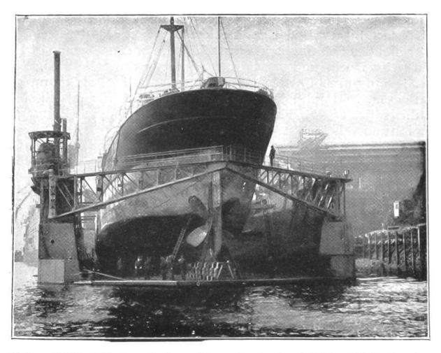
Kriegsschiff im Schwimmdock zur Reparatur der beschädigten Schiffschraube.
