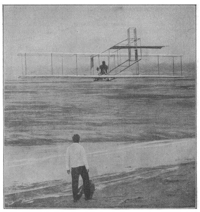
Orville Wright bei einem Versuchsfluge mit seinem neuen motorlosen Aeroplan, mit welchem er 9 Minuten 45 Sekunden bewegungslos in der Luft gegen einen starken Wind (80 km in der Stunde) schweben konnte.
