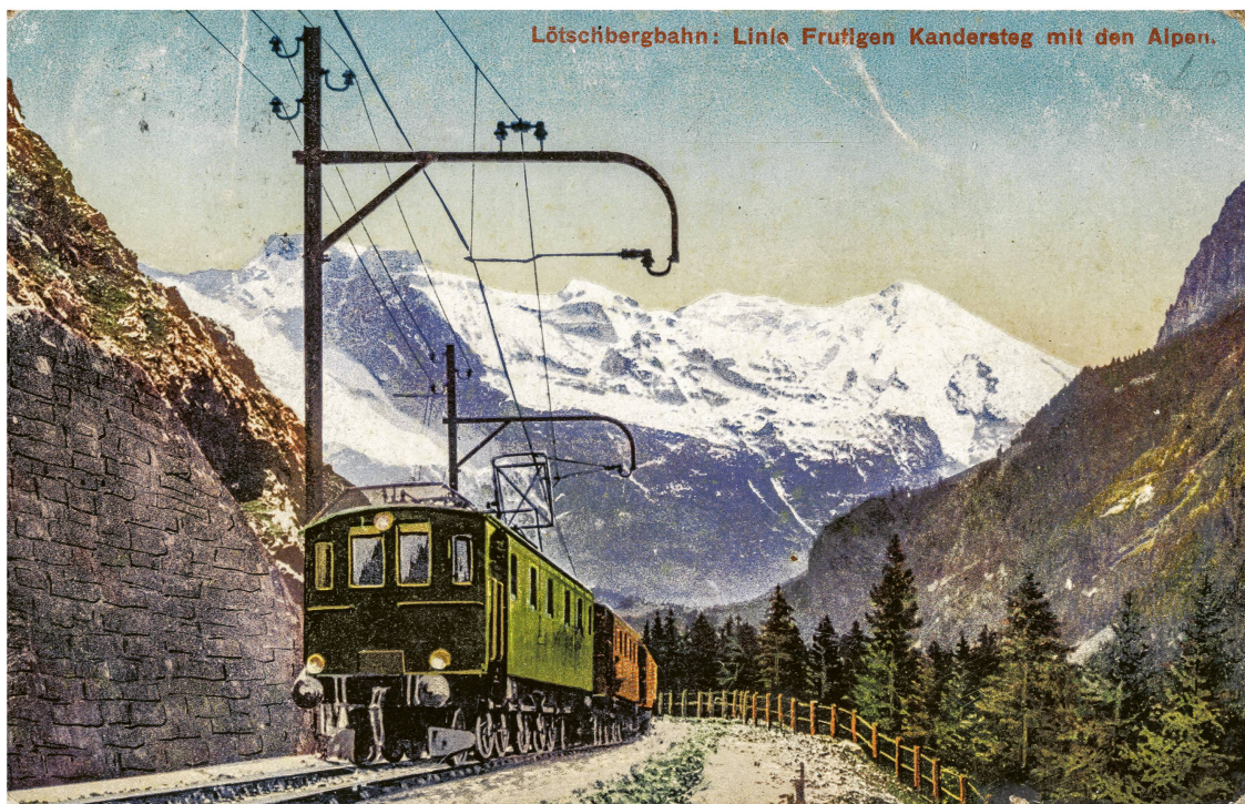
Die Lötschbergbahn wurde von Beginn an elektrifiziert. Das Kanderwerk in Spiez lieferte einen Teil des Stroms. Postkarte vor 1920.
