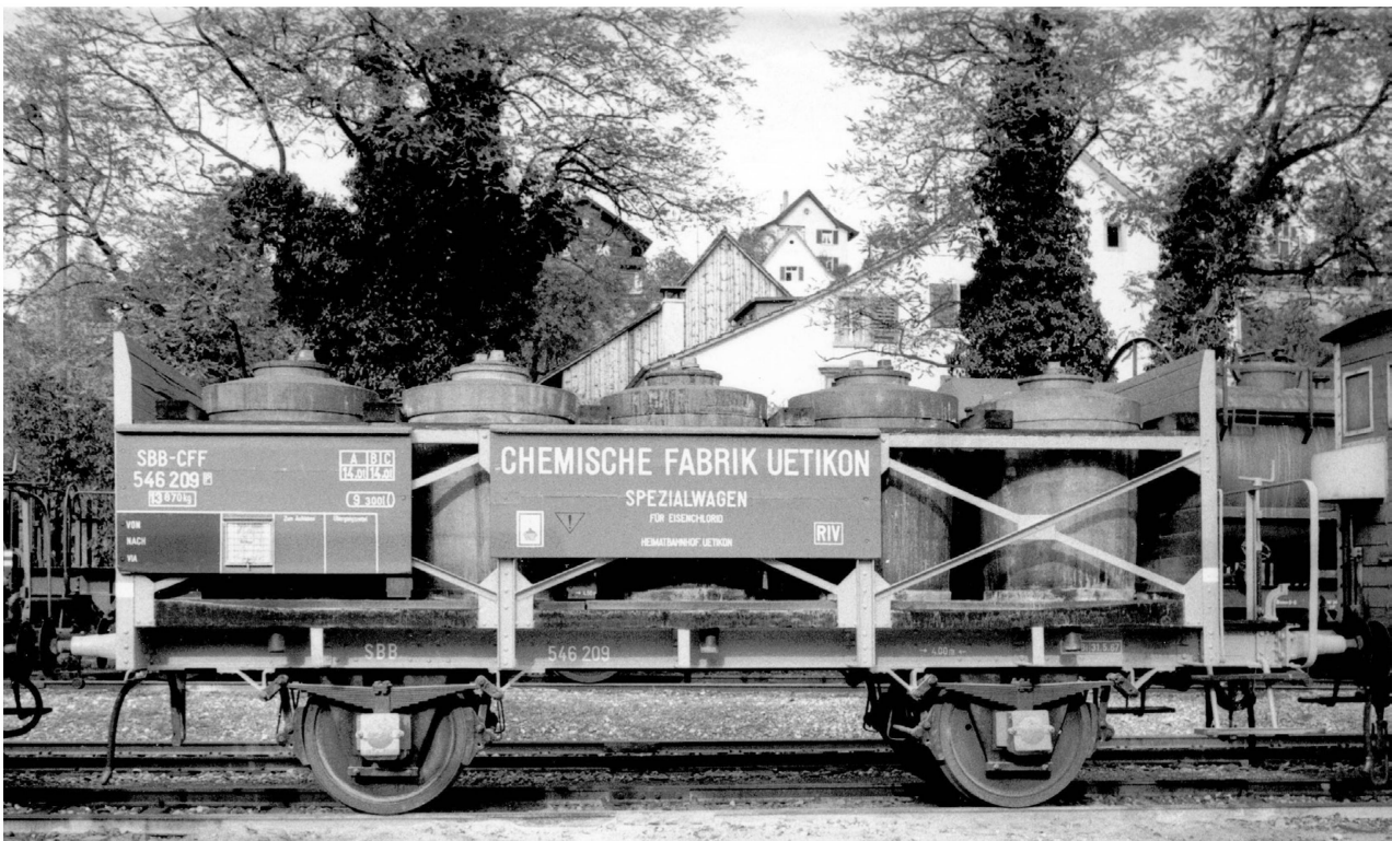
Topfwagen (Baujahr 1917) für den Transport von Eisenchlorid, 1967.
