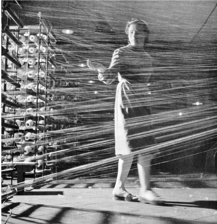
Zettlerei: Vorbereitung von Garnen für den Webvorgang, Ponte San Pietro, um 1950.
