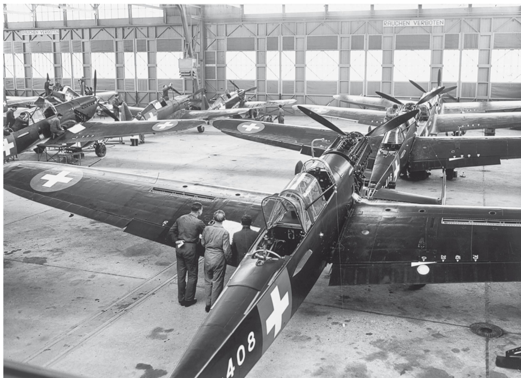
Mehrzweckflugzeug C-3603 in der Endausrüstung in den Konstruktionswerkstätten Thun, 1940. Im Hintergrund: Morane Jagdflugzeuge.
