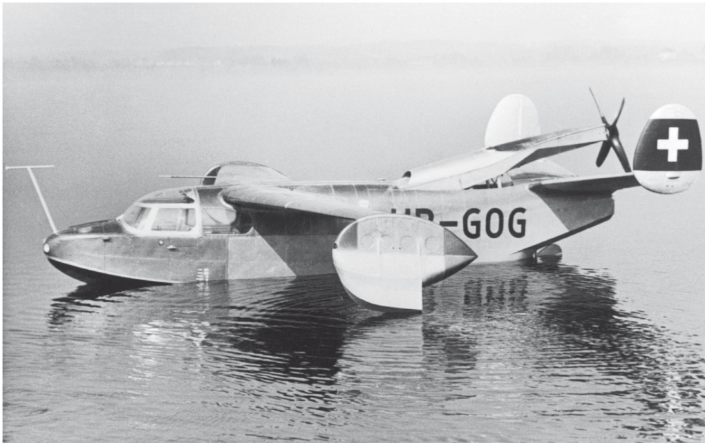
Das Reiseamphibium Do 212 auf dem Bodensee. Deutlich sichtbar die um ca. 15 Grad angehobene Antriebsanlage, ca. 1941. Das Projekt war ambitioniert ...
