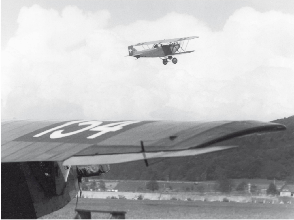
Der M8 nach dem Start. Diese letzte Flugzeugkonstruktion Haefelis bewährte sich nicht und wurde später zum M8a modifiziert.
