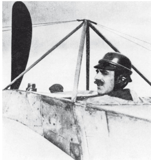
Edouard de Niéport in seinem Eindecker. Typisch für dieses Modell war der grosse Querschnitt des aerodynamisch vorteilhaft geformten Rumpfes, aus dem nur der Kopf des Piloten herausragte.
