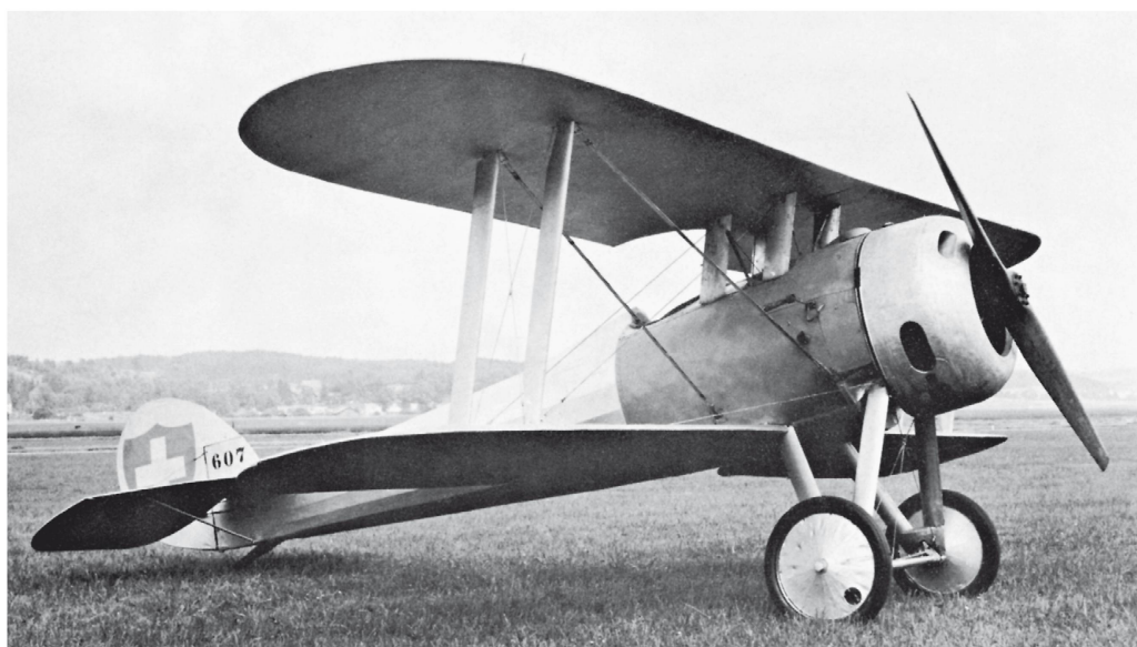
Nieuport N-28 C-1 «Bébé», 1917, mit 150 PS-Gnome-Rhône-Motor, wurde von den amerikanischen Truppen in Frankreich eingesetzt, landete wegen Motorenstörung 1918 bei Solothurn und wurde nachher in die Schweizer Fliegertruppe integriert.
