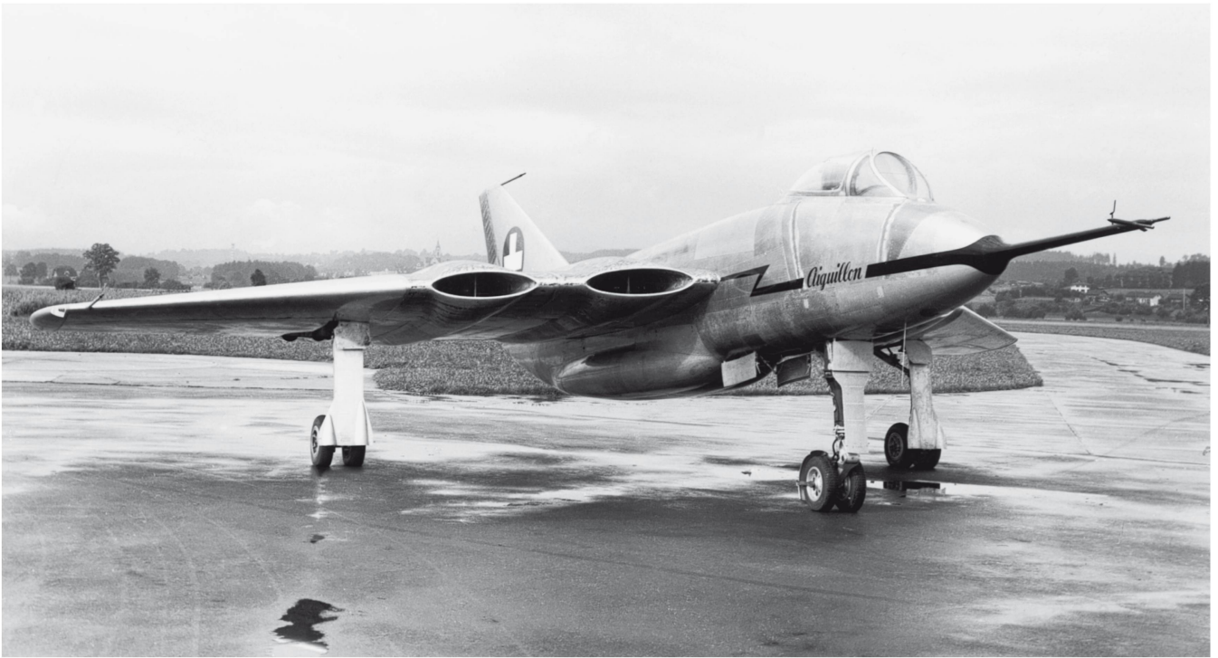
Prototyp des N-20.10 Aiguillon (Stachel). Die Wechselwanne ist gut sichtbar. Markant die vier im Flügel versenkten Turbofantriebwerke mit Zusatzverbrennung und das breitspurige Fahrwerk mit Niederdruckbereifung.
