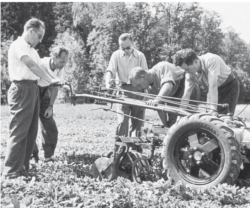
Konstrukteure und Versuchsmechaniker beim Feldversuch mit dem Prototypen eines Einachstraktors mit Ackerbaugerät, 1946.
