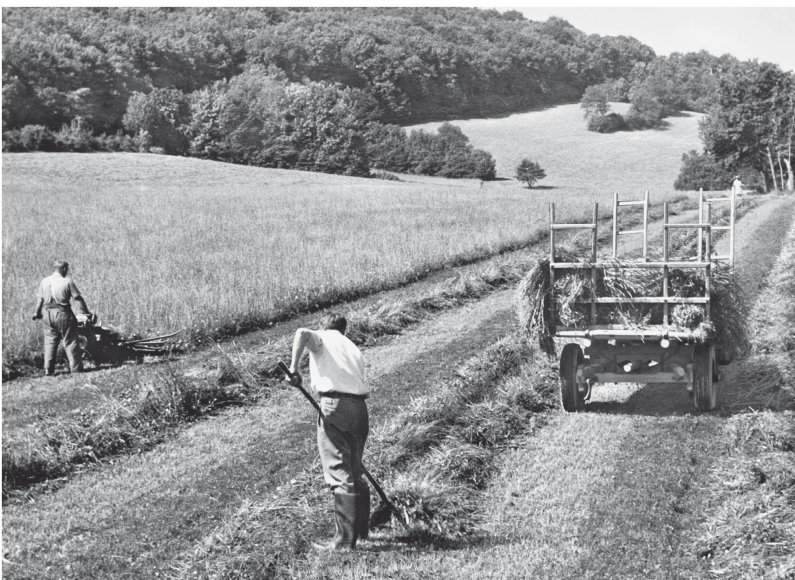
Mit dem angebauten Schwadenformer reduzierte der Motormäher «Rekord» das Eingrasen gemäss Prüfbericht «beinahe auf die halbe Arbeitszeit». Bild von 1951.
