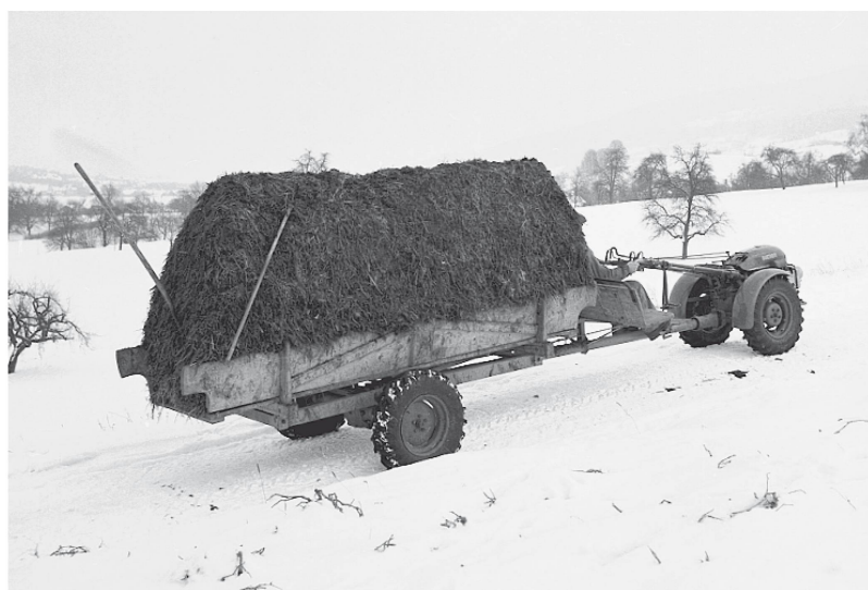
Die Zapfwelle des KT 10 übertrug die Kraft des Motors auf den Anhänger und erhöhte damit die Zugkraft auf das Vierfache. Kleintraktor mit Mistanhänger, 1953.
