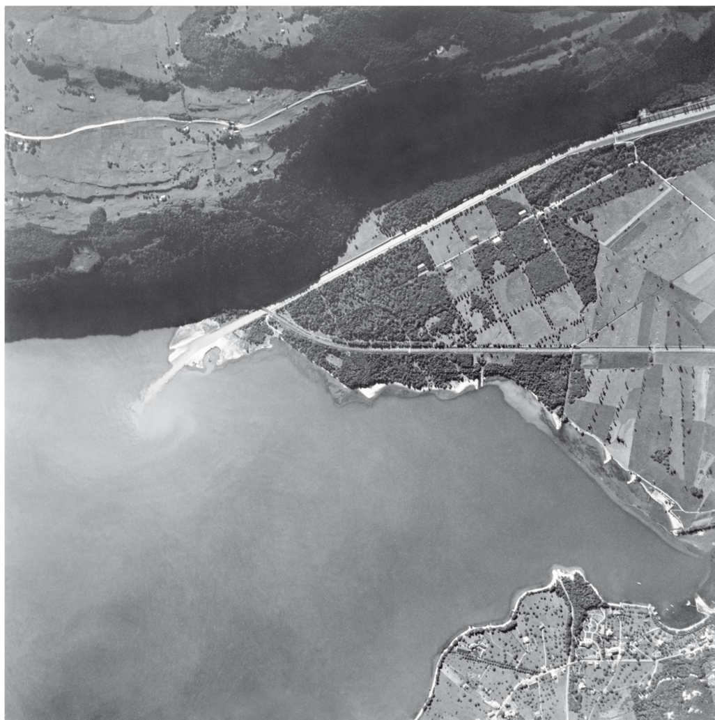
Luftaufnahme der Linthmündung in den Walensee von 1932. Das bewaldete Gebiet in der Bildmitte ist seit 1811, als der Escherkanal eröffnet wurde, aufgeschüttet worden.
