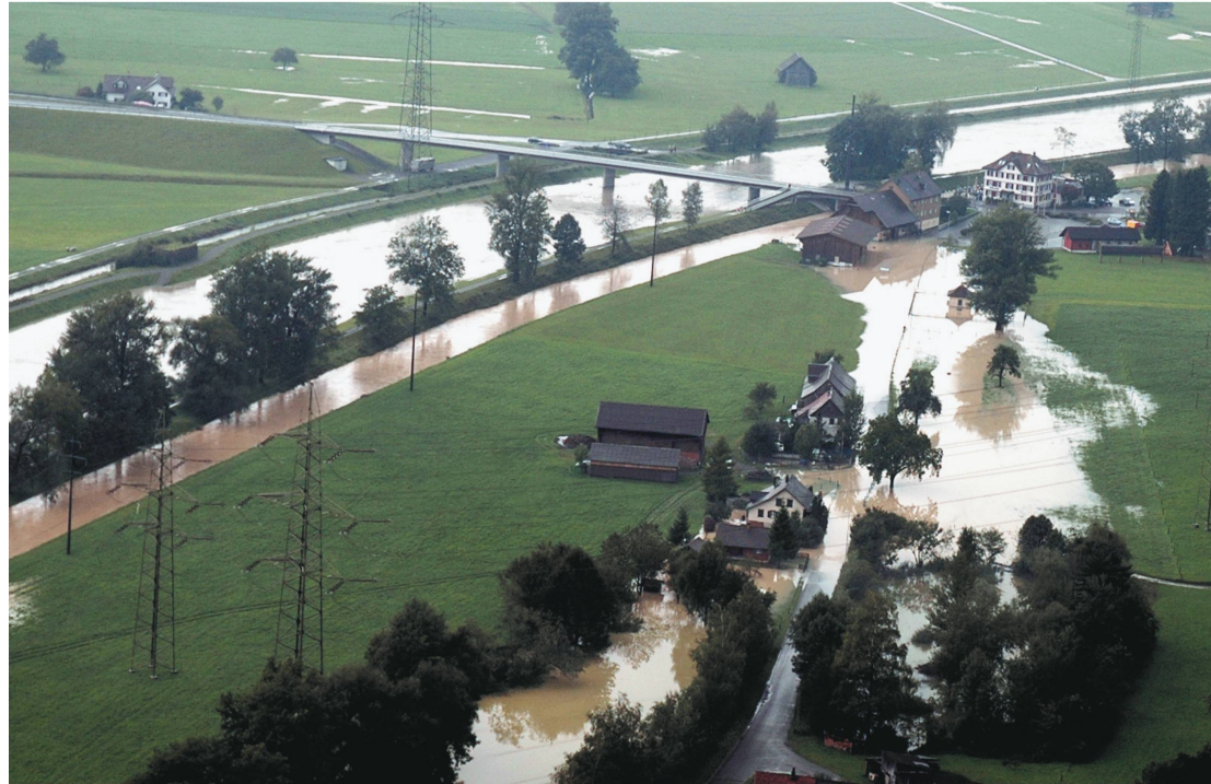
Hochwasser vom 23./24. August 2005: Situation bei Giessen. Ein Entwässerungs- kanal ist über die Ufer getreten. Das Über- schwemmungsgebiet stimmt weitgehend mit dem alten Linth- lauf überein.
