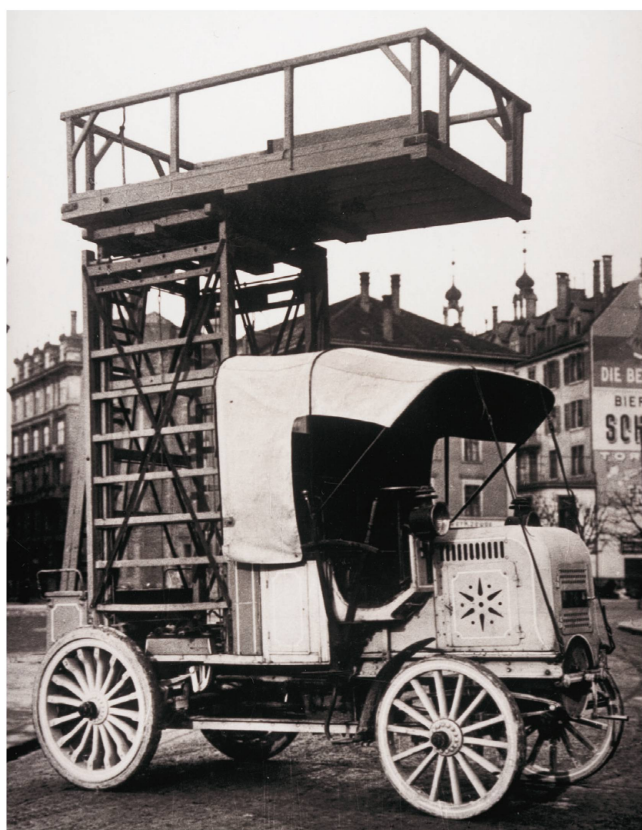
Der Daimler Omnibus nach der Übernahme durch die Stadt Zürich und dessen Umbau als Turmwagen für den Leistungsunterhalt der Städtischen Strassenbahn, 1905 bis 1915, Foto Peter Kamm, Zürich
