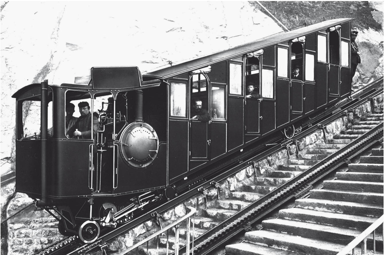
Zweiachsiger Dampftriebwagen mit quer zur Fahrtrichtung liegendem Kessel und gut sichtbarer talseitiger Antriebsdisposition.
