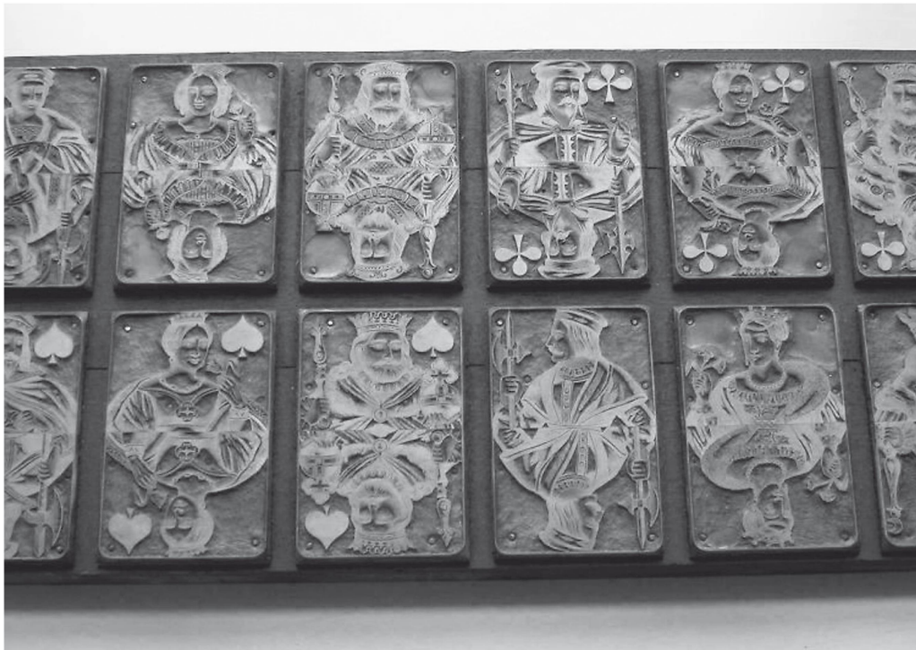
Oben und unten: Clichés für Kupfer- und Stahlstich
