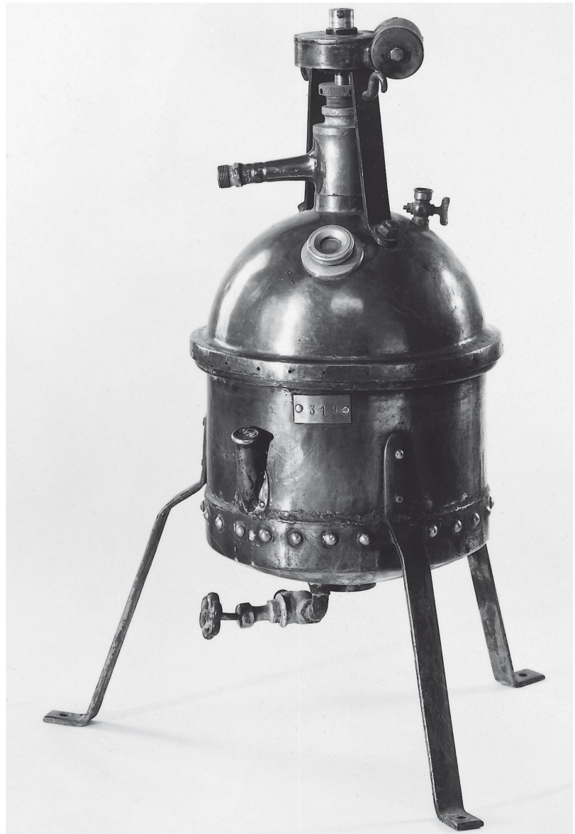
Der erste Eindampfapparat in der Firma Wander, bereits mit eingebautem Rührwerk, 80 cm hoch
