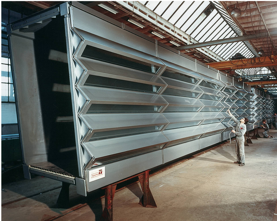
Fluggastbrücken Fingerdock Terminal A, Flughafen Zürich (links bei der Montage in der Werkhalle)
