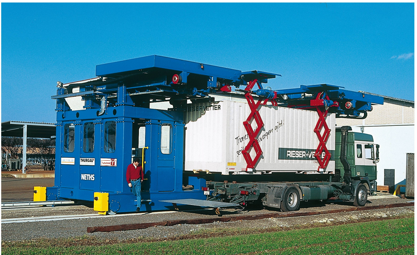
Umschlaggerät für den Containerumlad unter dem Fahrdracht der Bahnlinie
