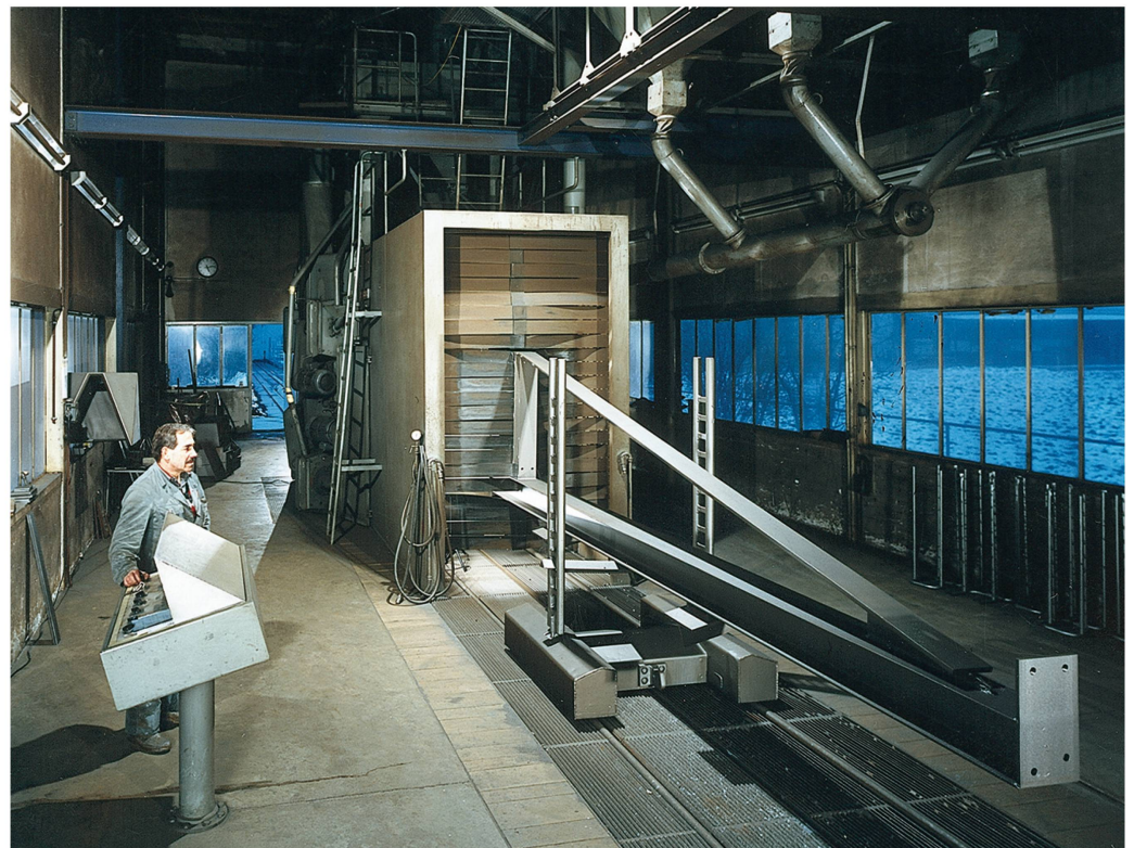
Strahlanlage für den Oberflächenschutz von Stahlteilen
