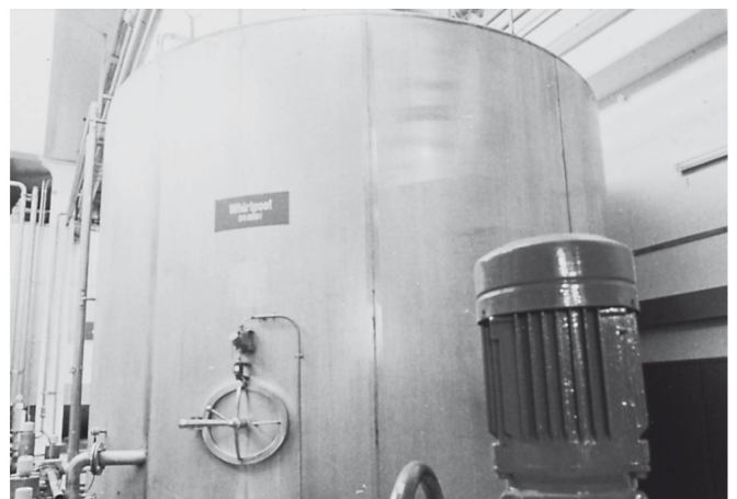
Im Whirlpool setzte sich der Trub ab, die Würze klärte sich.
