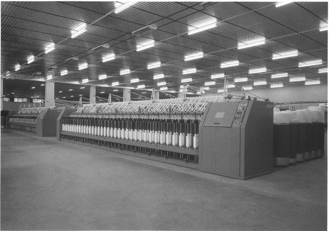
Flyer F1/1a mit Spulen 355x178 mm (14" × 7") und Alugussflügeln um 1990
