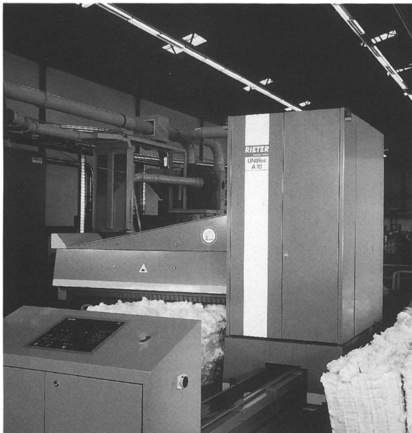
Ballenabtragmaschinen UNIfloc öffnen das Rohmaterial in kleine Flocken.
