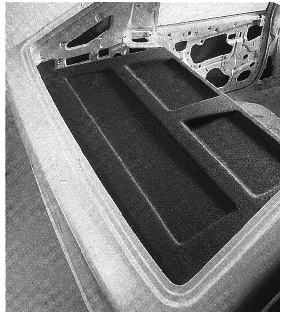
Hutablage als Beispiel eines multifunktionalen Dämmelementes
