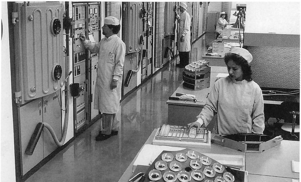
Optik-Beschichtung bei Leica in Heerbrugg: Die Werkhallen gleichen heute mehr einem medi- zinischen Laboratorium als einer Fabrik
