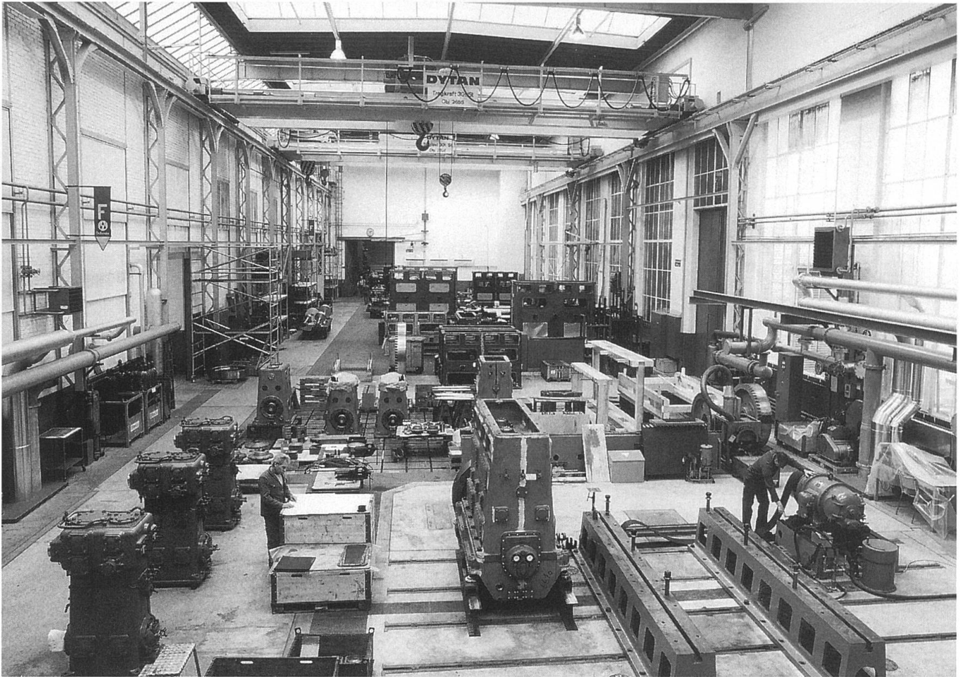
Montage der Kompressoren in Oberwinterthur
