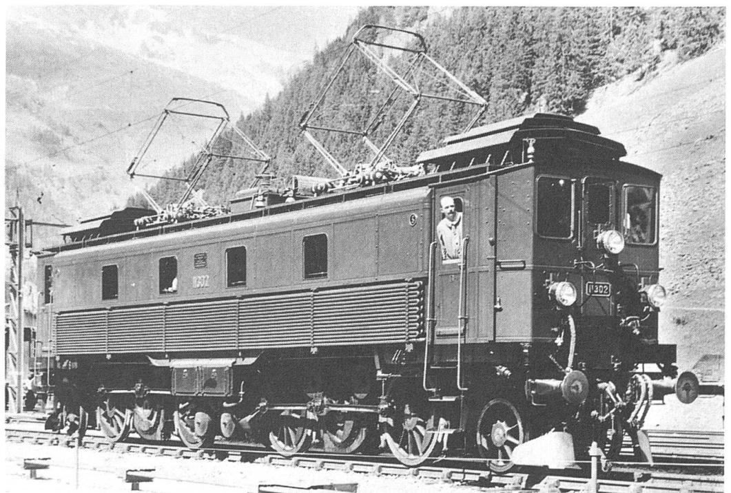
Schnellzuglokomotive Be 4/6, gebaut 1919 für die elektrifizierte Gotthardstrecke
