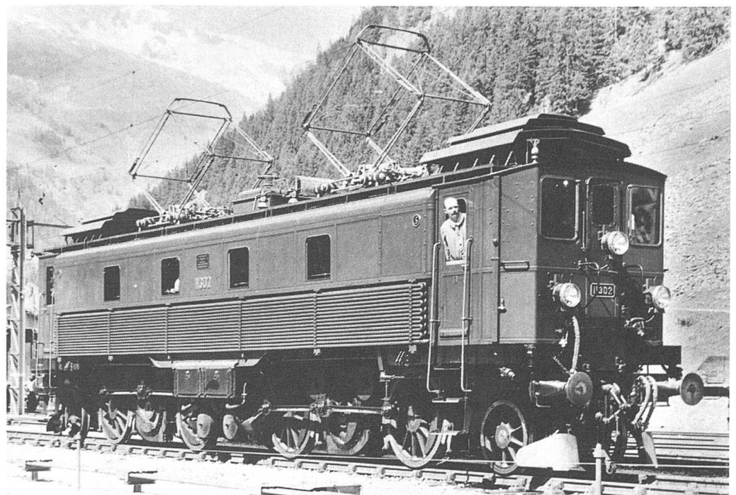
Schnellzuglokomotive Be 4/6, gebaut 1919 für die elektrifizierte Gotthardstrecke
