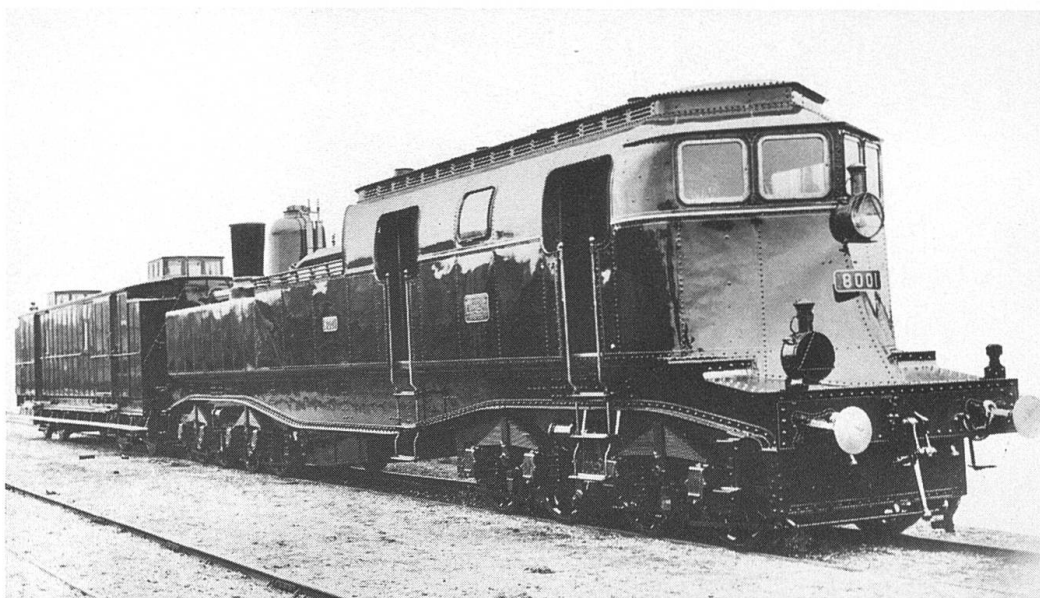
Dampfelektrische Lokomotive System Heilmann (1896)
