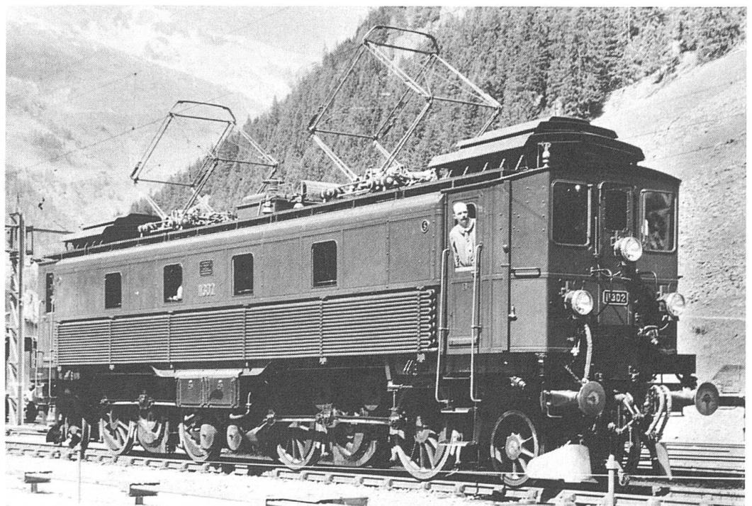
Schnellzugslokomotive Be 4/6, gebaut 1919 für die elektrifizierte Gotthardstrecke
