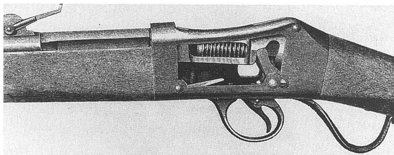
Fig. 80. Ansicht des englischen Martini-Henry-Gewehrs. (Gespannt; linkes Schlossblech weggenommen.)
