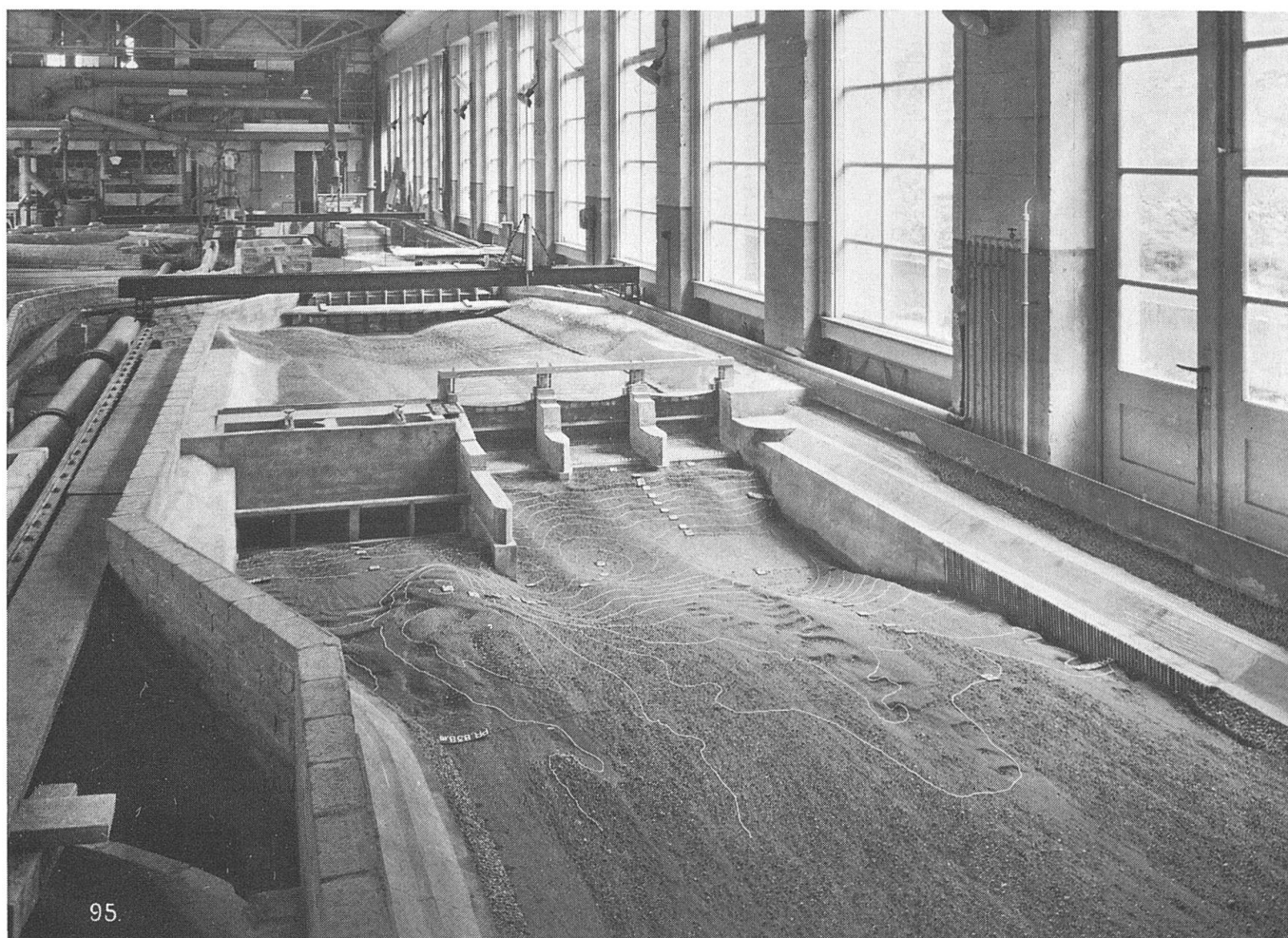
Halle der Versuchsanstalt für Wasserbau mit im Vordergrund dem Modell des 1938 bis 1942 erstellten Rheinkraftwerkes Rekingen AG
