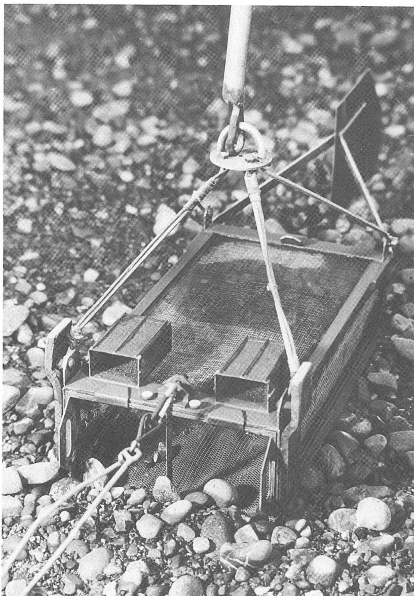
Geschiebemessgerät für die internationale Rheinregulierung in Arbeitsstellung
