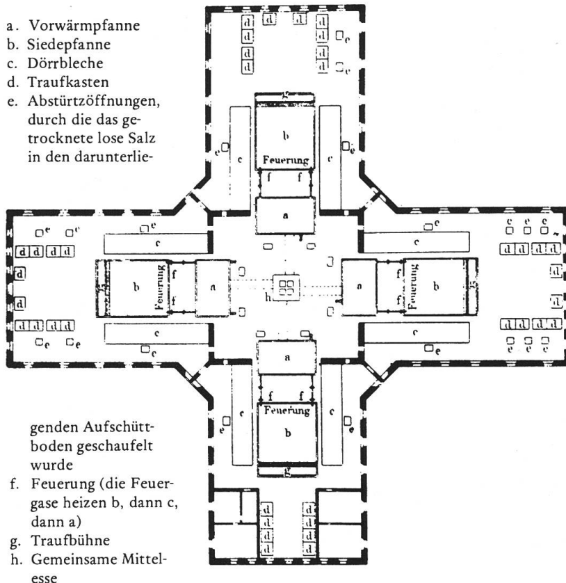
Grundriss des Sudhauses mit den Pfannenanlagen der Saline Traunstein, um 1790
