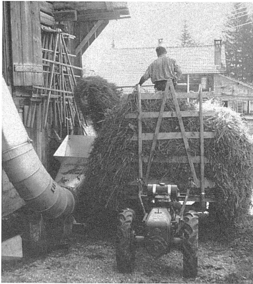
AEBI-Schleusengebläse 1957, für die Förderung des Heus von der Ladebrücke auf den Heustock. Das Heu wird von einem Einachstraktor mit Triebachsanhänger transportiert, dem Vorgänger des AEBI-Transporters
