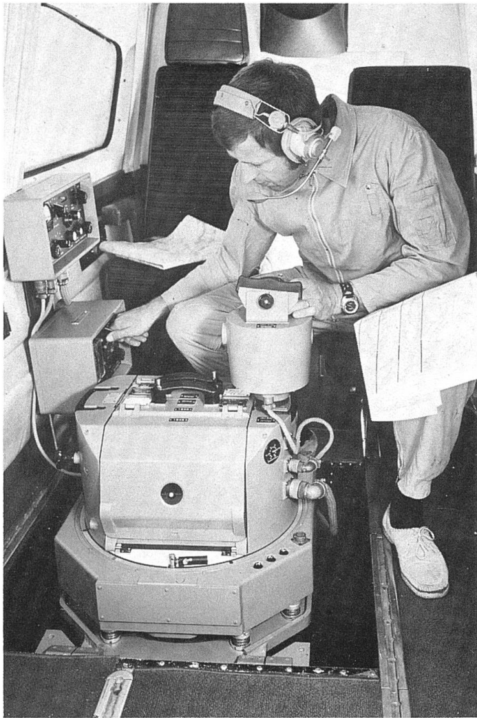
Die automatische Reihenbildkammer Avio-phot Wild RC 10 ist im Vermessungsflugzeug eingebaut und hält das überflogene Gelände in Senkrechtaufnahmen fest.
