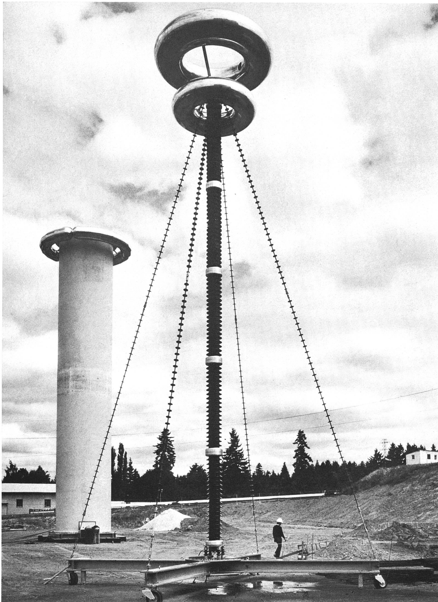
Stoßgenerator in Freiluftaufstellung zur Imitation von Gewitterüberspannungen. Maximale Spannung 5,6 Mio Volt. Aufgestellt in Portland (Oregon, USA) bei der Bonneville Power Administration.
