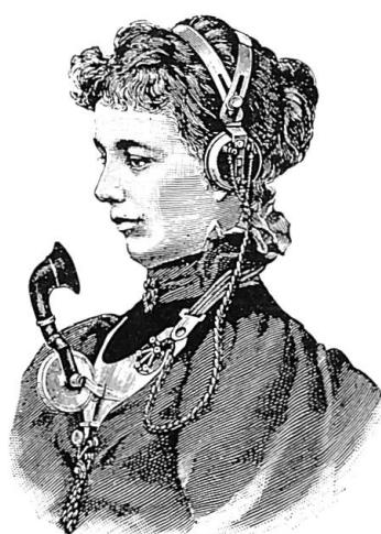
Ausrüstung der Telephonistin: Kopfhörer mit Bügel und stehendem Mikrophon.
