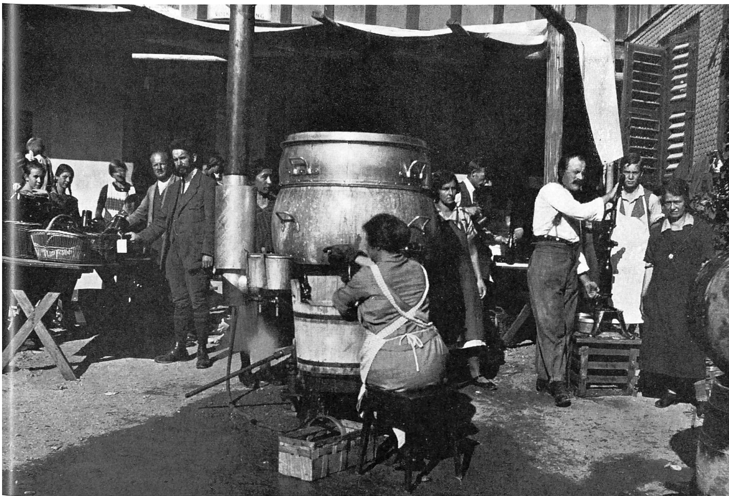
Die Süßmosterei wurde durch Loders Vorgehen populär. Hier ist an die Stelle des Tiefdruckkessels ein leistungsfähiger Hochdruckkessel getreten.
