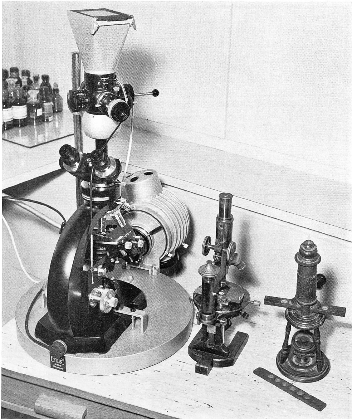
Mikroskope einst und heute. Rechts eines der ersten Mikroskope, das Müller-Thurgau 1877 als schon damals seltene Rarität geschenkt erhielt. In der Mitte das Mikroskop, mit dem Müller-Thurgau während Jahrzehnten gearbeitet hat. Es enthält ein Monokular mit bloßem Hellfeld, mit dem das Arbeiten für die Augen sehr mühsam war. Das Gesehene mußte von Hand auf das Papier gezeichnet werden. Links das heutige Zeiß-Forschungsmikroskop WC, mit Dunkelfeld, Hellfeld, Phasenkontrast, UV-Mikroskop und Photoaufsatz.
