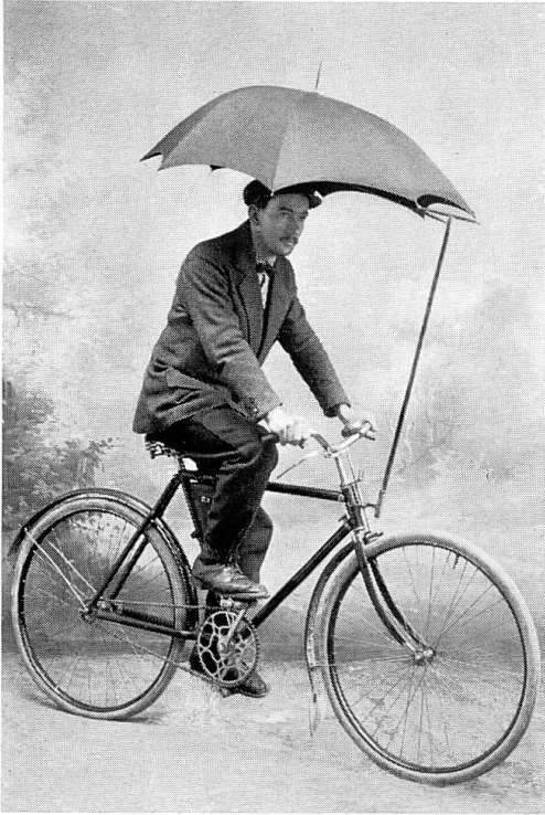
Der Regenschirm und seine Befestigung am Fahrrad, eine Erfindung, die Busch 1913 zum Patent anmeldete.
