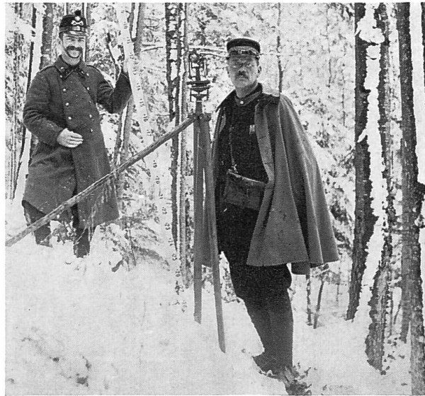
Aktivdienst 1914/18 am Hauenstein. Hauptmann Gruner beim Nivellieren, wozu behelfsmäßig ein Theolith und eine Setzlatte dienen.
