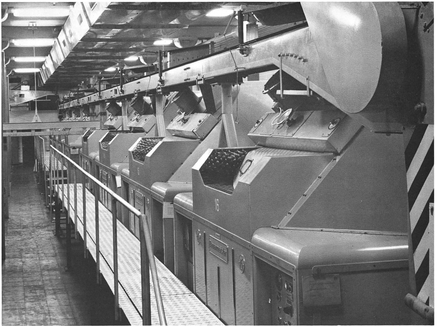
Moderne Conchen sind programm- gesteuert. Anders als die früheren Formen, verbergen sie dem Laien ihre Zweckbestimmung und Ar- beitsweise.
