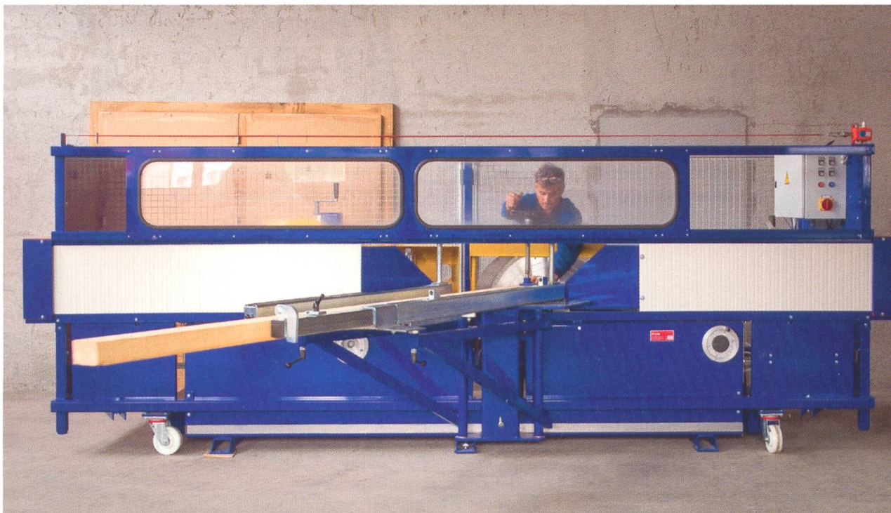
Die ZA-66/95 mit zusätzlicher Schutzvorrichtung/baumeistergeprüft.
