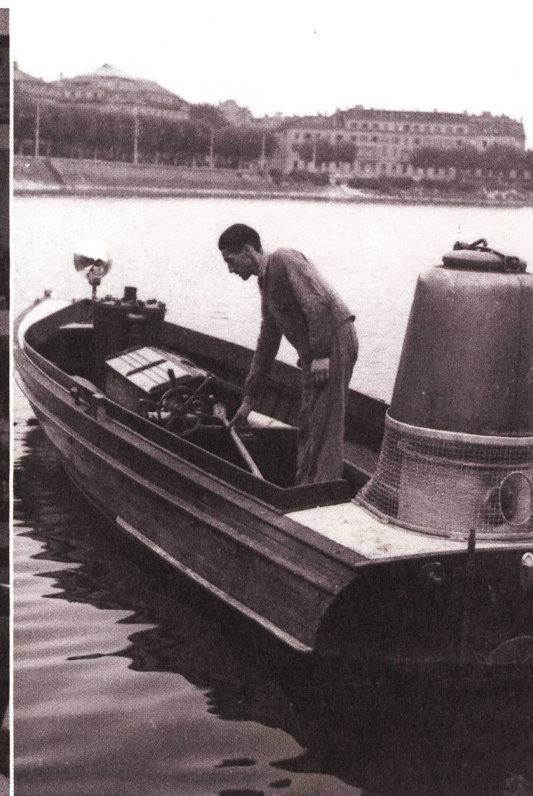
Das erste Motorboot mit Holzgasgenerator auf dem Neuenburgersee, 1943. Die Reinigung des Gases erfolgte durch Spezialfilter mit Wasser aus dem See.
