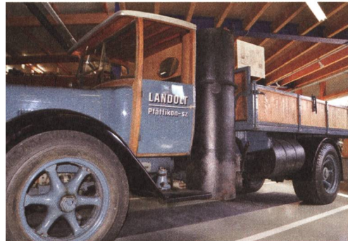
FBW-Kipper-Transporter, Baujahr 1929, umgerüstet auf Holzvergaser.
