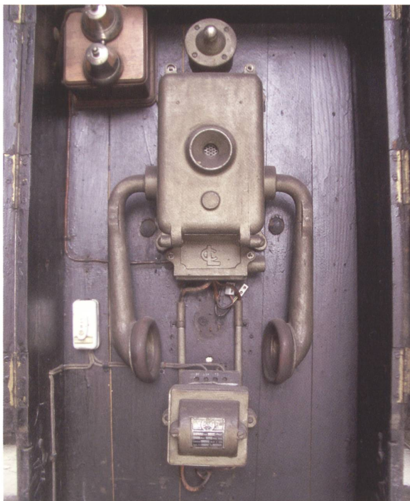
Ein solcher Apparat mit vertikal ausschwenkbaren Hörrohren wurde von Paul Schwestermann, Brig, gerettet und ist noch vorhanden (Bild René Zuber).
