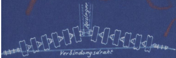
Abspannisolatoren bei Abweichung der Leitungsrichtung von der geraden Linie (Draufsicht).
