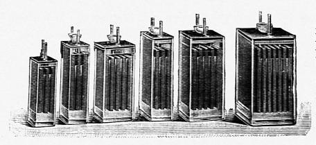
oxydschicht, während die negative Elektrode eine blanke Bleiplatte darstellt. Wenn man jetzt die Batterie ausschaltet, bilden Bleisuperoxyd und
