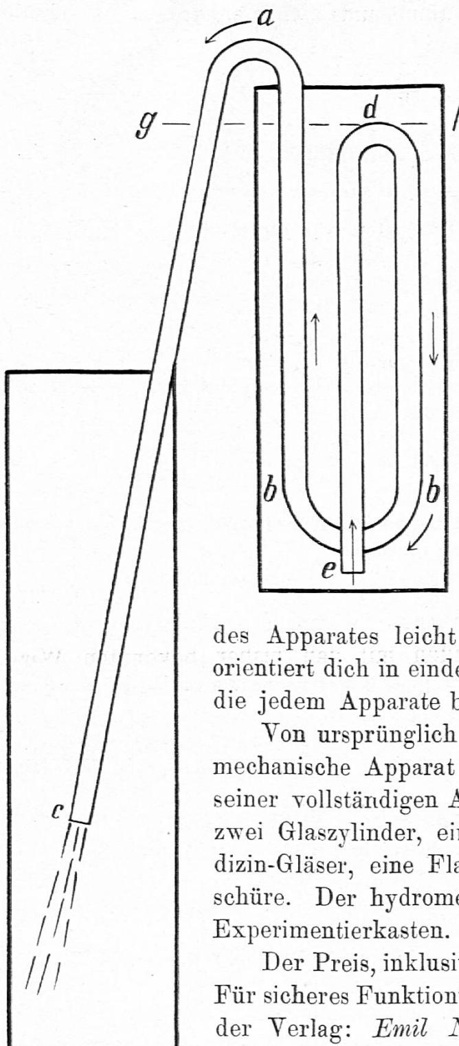
weiter den Scheitel *a* und tritt in die Röhre *ac* ein. Sowie sie ein wenig unter dem Punkt *g* ist, erfolgt der Ausfluss nach dem Gesetz des gewöhnlichen Hebers.
