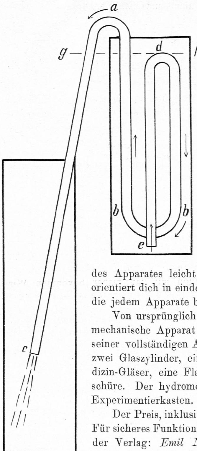
weiter den Scheitel *a* und tritt in die Röhre *ac* ein. Sowie sie ein wenig unter dem Punkt *g* ist, erfolgt der Ausfluss nach dem Gesetz des gewöhnlichen Hebers.
