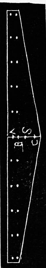
4. Dann können alle vorigen Versuche in folgender Weise repetirt werden, indem durch Aufhängen eines 50 Gramm Gewichts in  $s$  das Gewicht des Wagbalkens bei unveränderter Schwerpunktslage vergrössert wird, wodurch der Einfluss des Gewichts des Wagbalkens sich darstellen lässt.
