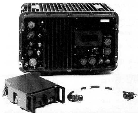
Das Feuerleitsystem FARGO ist ein elektronisches Artillerie-Feuerleitsystem für Batterien mit bis zu sechs Geschützen. Es errechnet Höhen- und Seitenwinkel sowie weitere Schiess-elemente und übermittelt diese Werte vom Artillerie-Beobachter über Draht oder Funk an Anzeigegeräte an den Geschützen.
