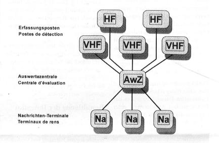
Die 5 Erfassungsposten ermitteln und identifizieren die Emissionen und werten die Meldungsinhalte aus, soweit sie lesbar sind. Das Material der Erfassungsposten wird örtlich aufgeteilt: Am besten Antennenstandort werden die Antenne und die zugehörigen, fernsteuerbaren Geräte aufgebaut. All diese Teile sind in tragbaren Transportkoffern untergebracht.
