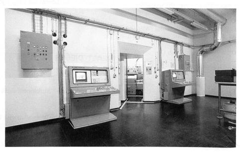
Zelle für isostatisches Pressen mit Bedienraum
