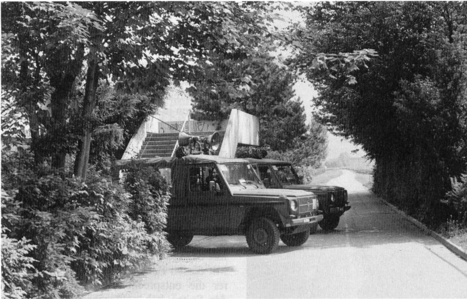
Lautsprecheranlage LVA 71 auf Puch G montiert
