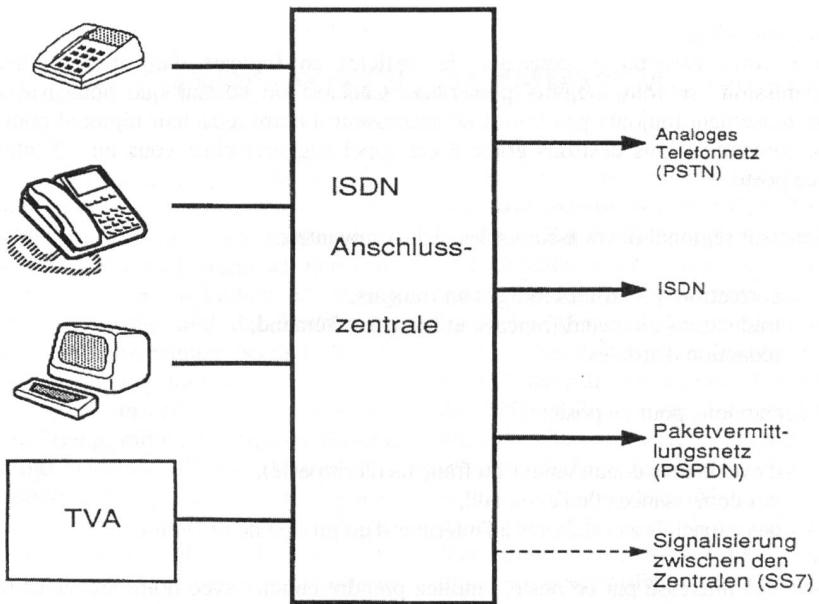
wobei auf die Behandlung der Protokolle verzichtet wird. Diese werden in einem späteren Kapitel im Detail behandelt. Betrachtet man das architektonische Konzept von ISDN, so ist ersichtlich, dass die Teilnehmer-Schnittstelle eine klare Trennung zwischen der Zuständigkeit des Netzbetreibers und des Teilnehmers erlaubt.
