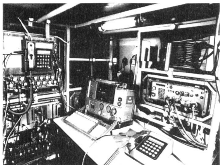
Knotenvermittler in einem Puch-Geländewagen eingebaut
