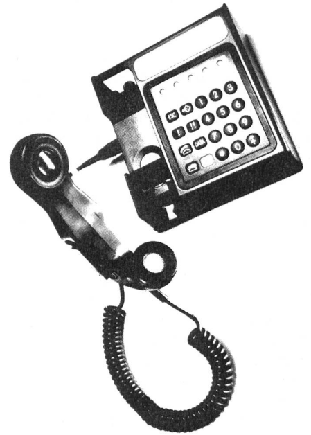
Digitaler Telefonapparat, speziell für IMFS entwickelt
