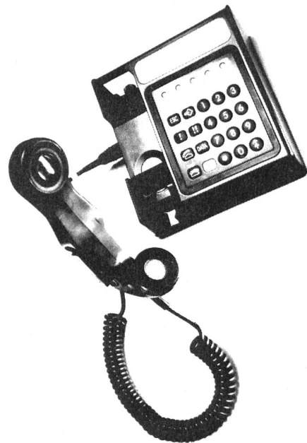
Digitaler Telefonapparat, speziell für IMFS entwickelt
