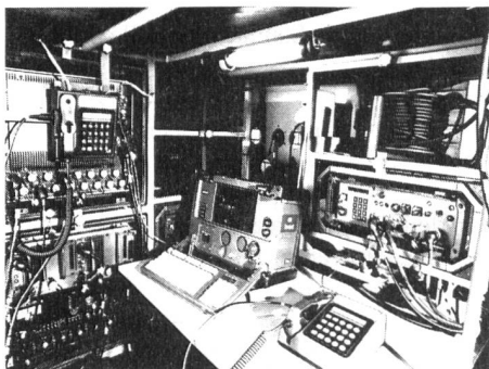
Knotenvermittler in einem Puch-Geländewagen eingebaut
